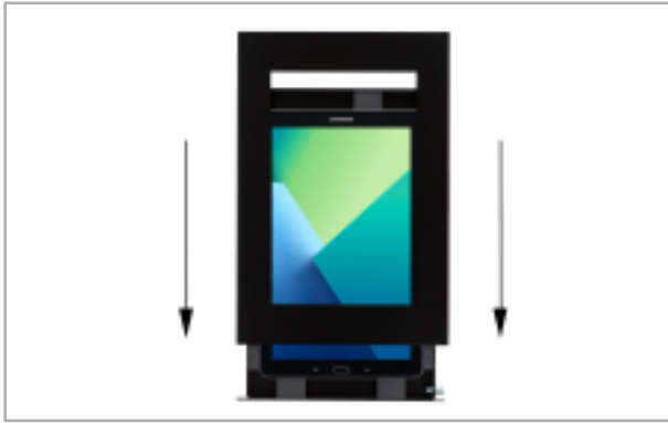
Abb. 5: Rahmen raufschieben und Sicherheitsschraube festschrauben
