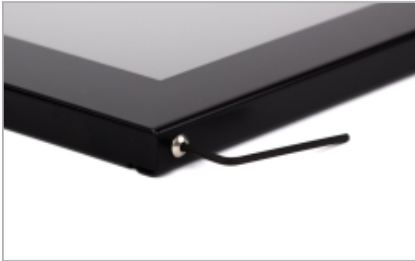
Abb. 2: Schraube am Rahmen lösen
