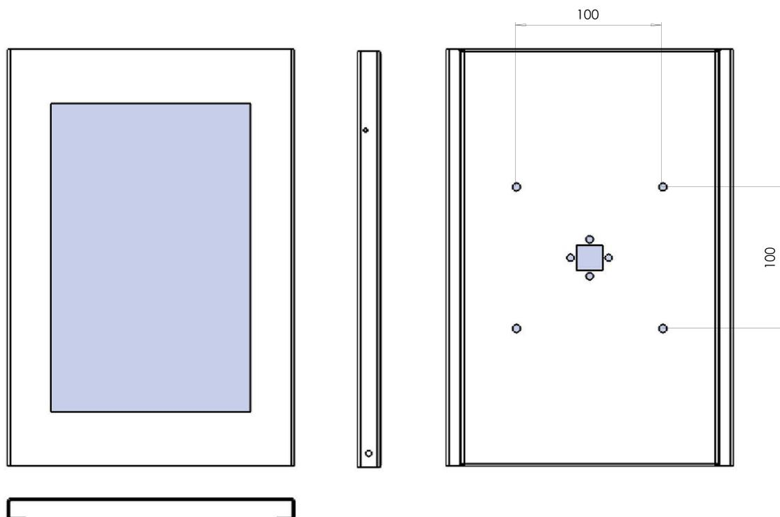
Abb. 1: VESA-Aufnahme der TabLines TSG Tablet Schutzgehäuse
