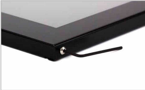
Abb. 2: Schraube am Rahmen lösen
